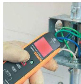
Verifica rapida della presenza di tensione senza toccare conduttori alimentati.
